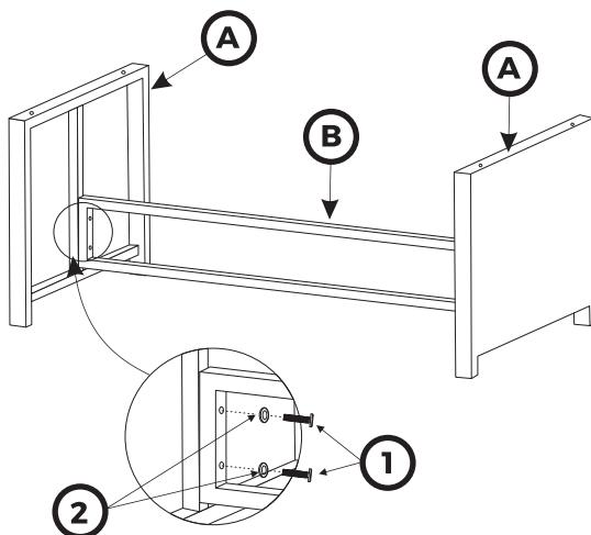
**ÉTAPE 2** À l'aide des boulons M6x30 mm (1) et des rondelles M6 (2), fixez dessus de la table (C) aux panneaux latéraux de la table (A).
